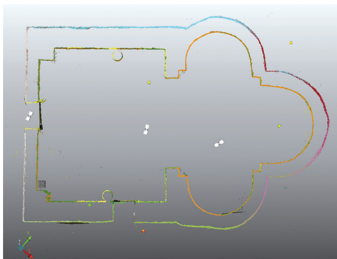
Vue en plan de la chapelle de la Trinité, réalisée à partir du traitement informatique du relevé 3D laser. Chaque couleur représente une station du scanner laser 3D.
